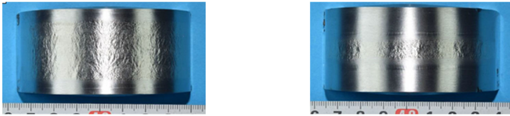
図 10 ビード縦曲げ試験結果（左：表曲げ，右：裏曲げ，いずれも欠陥無し）
