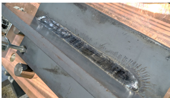
図 12 短絡解除制御の効果
