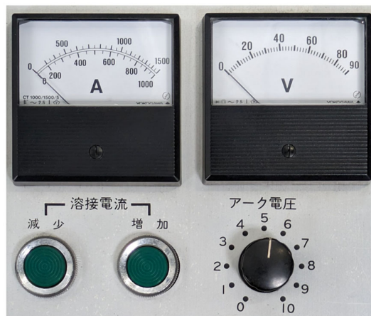
図 4 アナログサブマージアーク溶接システムの操作部
