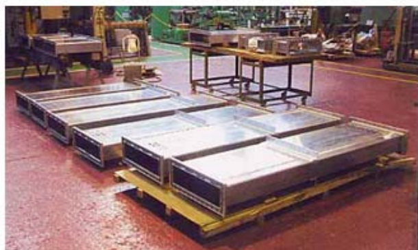
図 12 大型 FSW 角管の粒子加速器用導波管への適用
