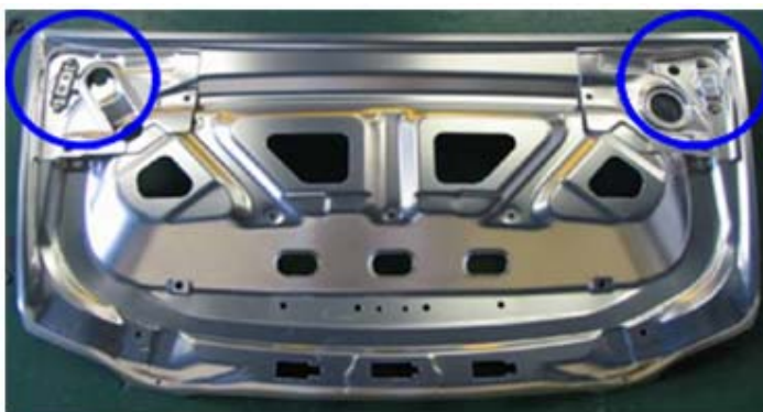
図 17 FSW 点接合による異種金属接合の自動車への応用
