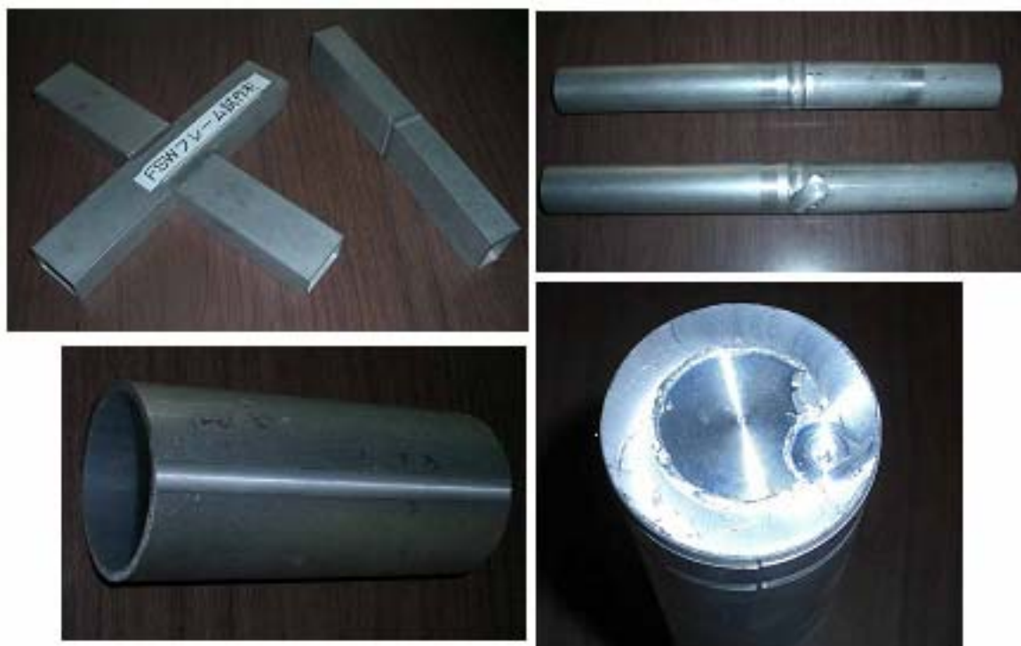
図 9 各種 FSW 継手形状
