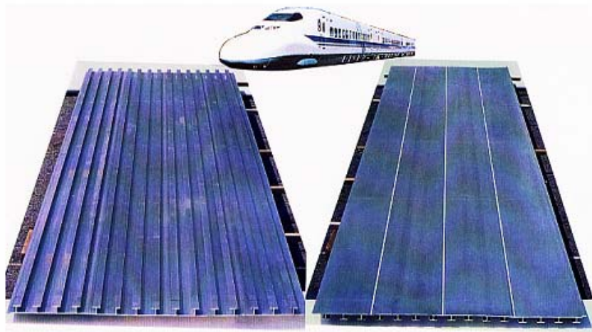
図 2 700 系新幹線用 FSW 床材
