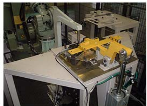
図 17 FSW 点接合による異種金属接合の自動車への応用
