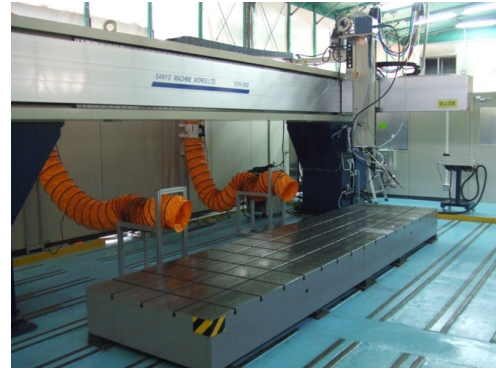
図4 レーザ・アークハイブリッド溶接装置
