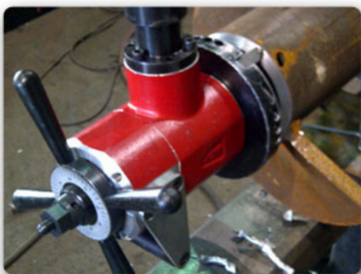
図 1 開先加工機 (小径管の端面加工)
