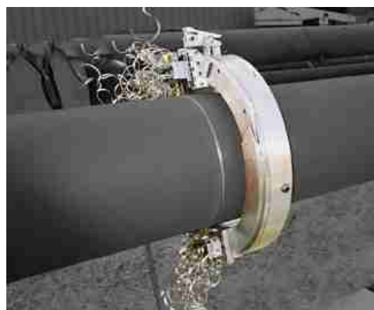
図 2 開先加工機 (切断、開先加工同時施工)
