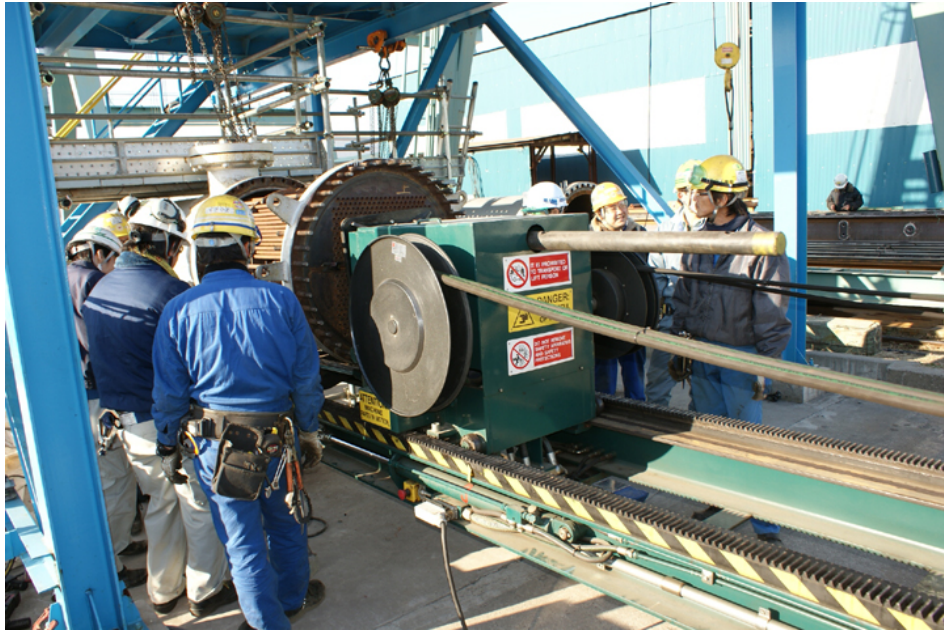
▲屋外実技ワークショップで行われていた熱交換器分解整備 (ハイドロエキストラクター操作)
