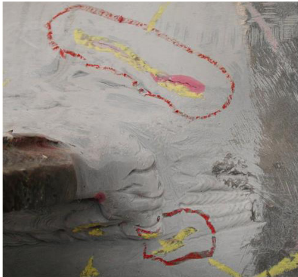
図4 FCC フリューガスラインの溶接部に発生した割れ
